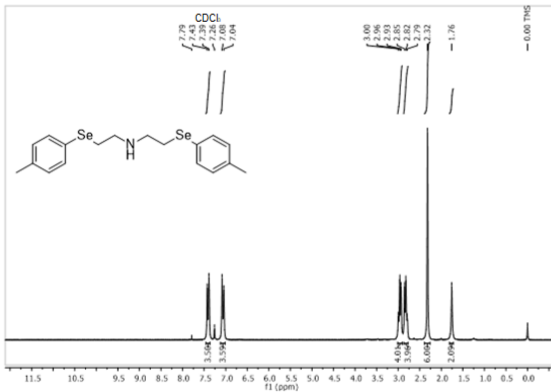
Figura 26. Espectro de NMR de ^1H (200 MHz) do ligante L_{Me} em CDCl_3 .
