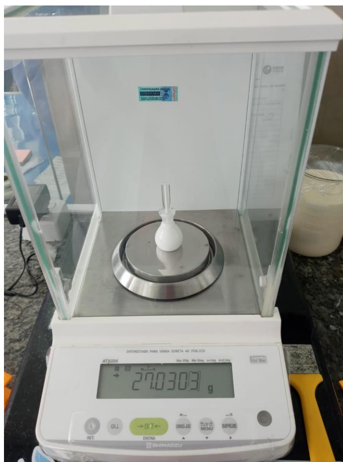
Figura 9. Determinação de densidade relativa com a pesagem de um picnômetro com amostra.
