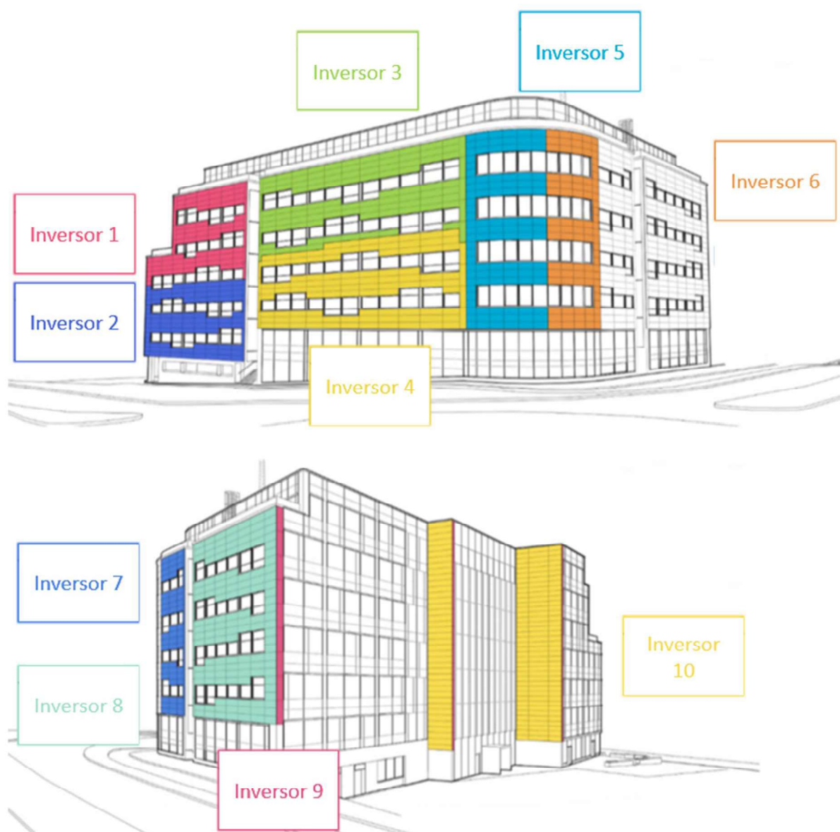
Figura 24 – Divisão do sistema conforme inversores
