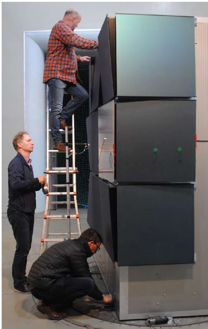
Figura 12 – Protótipo de uma fachada utilizando módulos BIPV
