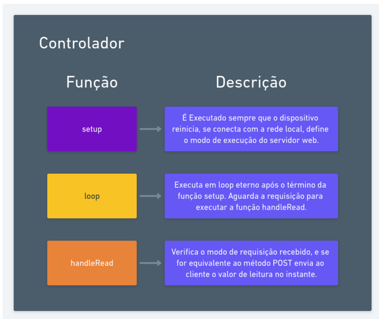
Figura 41 – Esquema da programação do dispositivo
