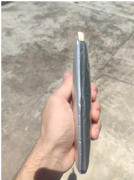
Figura 28 – Célula de Lítio-ion da equipe Fórmula CEM apresentando estufamento
