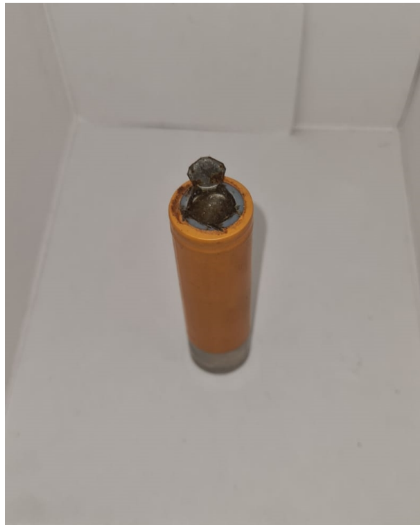
Figura 29 – Célula de Lítio-ion de um parceiro da equipe Fórmula CEM apresentando rompimento da válvula de segurança
