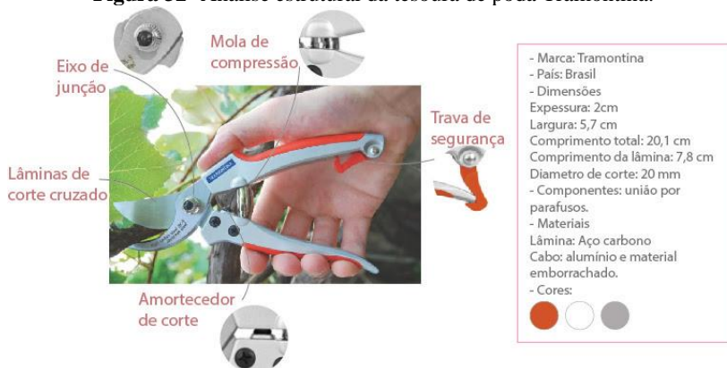
Figura 32- Análise estrutural da tesoura de poda Tramontina.
