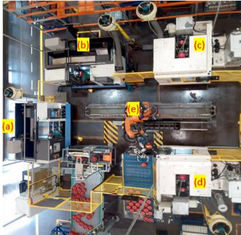
Figura 9 - Célula robotizada utilizada para a aplicação do monitoramento. (a) Torno utilizado no projeto, (b) Torno, (c) Fresa, (d) Fresa, (e) Robô
