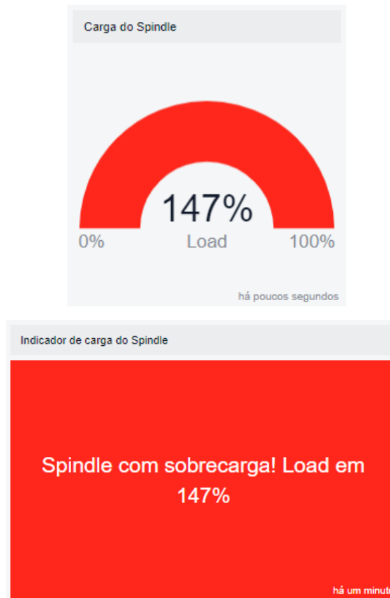
Figura 29 - Indicador de carga do spindle sobrecarregado.
