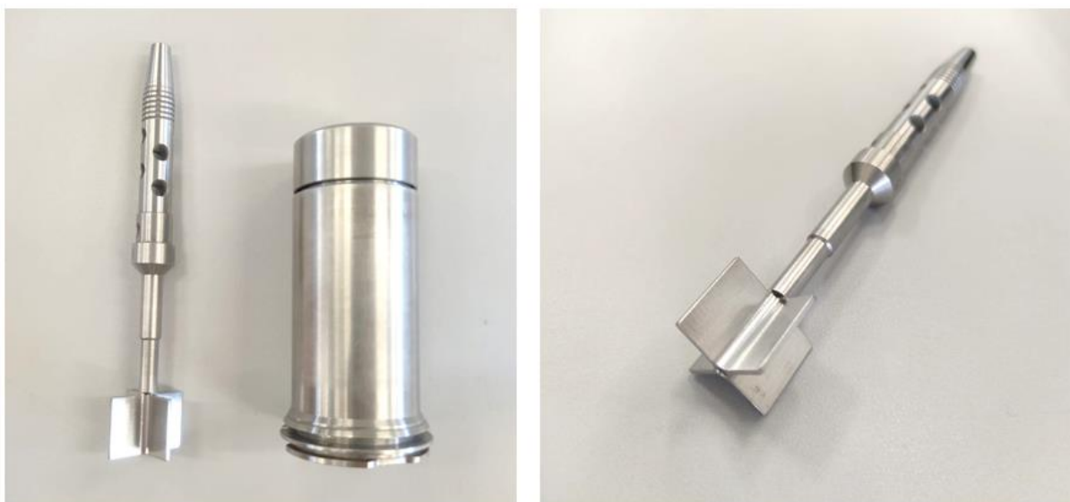
Figura 32 – Geometria tipo Vane utilizada nos ensaios reológicos
