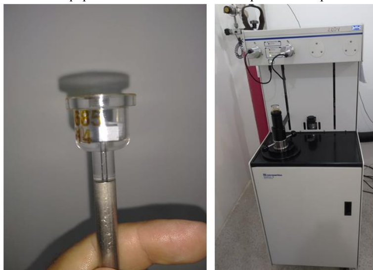
Figura 35 - Amostra e equipamento utilizado no ensaio de porosimetria por intrusão de mercúrio
