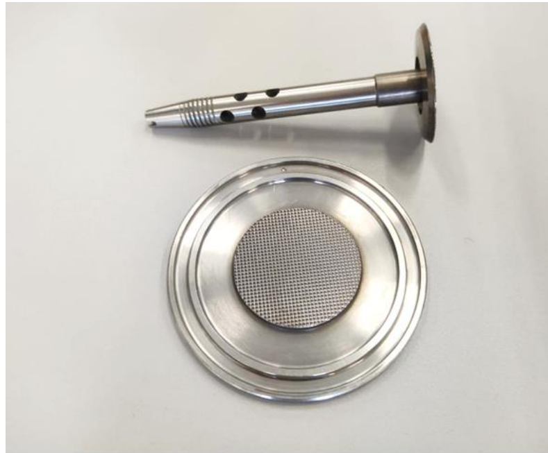
Figura 36 - Geometria de placas paralelas utilizada nos ensaios reológicos na Etapa 5 da pesquisa
