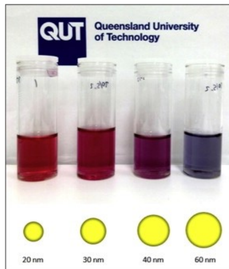
Figura 5 – Fotografia de dispersões de AuNPs de diferentes tamanhos (diâmetro entre 20 e 60 nm) desenvolvidas pelo método de redução utilizando citrato.
