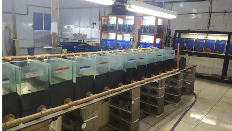
Figura 14: Sistema de recirculação utilizado para experimento de larvicultura de G. brasiliensis com utilização de rotíferos e copépodes. Fonte: Elaborado pelo autor.
