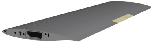
Figura 1.9 – Esquemático da aplicação de um material poroso em um perfil de asa. Extraído de (HERR; ROSSIGNOL; DELFS, 2014).
