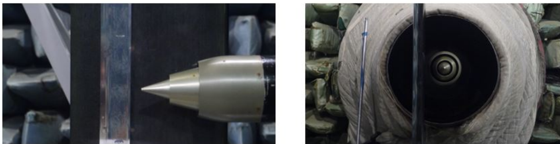
Figura 5.36 – Fotografia do teste realizado no TsAGI com perfil de aerofólio extrudado e flap afiado angulado em 15^\circ e todas as cavidades fechadas.
