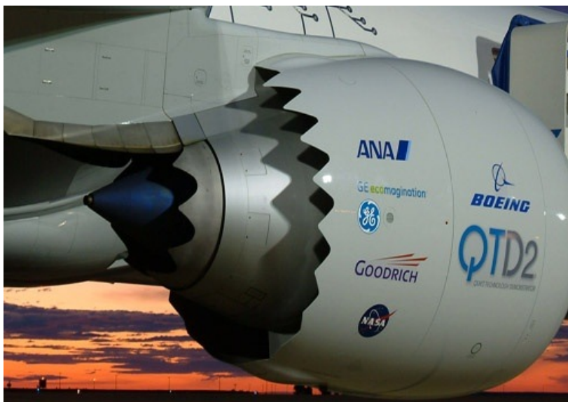
Figura 1.6 – Aplicação de chevrons em aeronave Boeing 777. Retirado de < https://www.nasa.gov/topics/aeronautics/features/bridges_chevron_events.html >.
