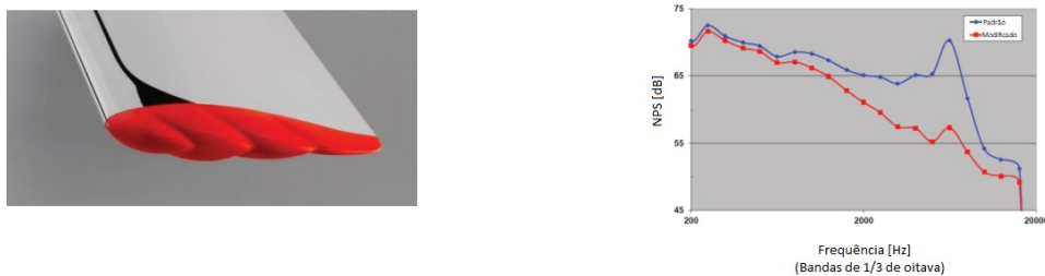
Figura 2.29 – Geometria excêntrica de bordo lateral e redução de ruído proporcionada. Retirado de (REICHENBERGER, 2016).
