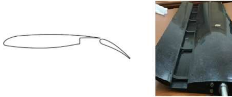
Figura 5.35 – Desenho esquemático de um perfil de aerofólio 0P30N e fotografia do perfil ensaiado.
