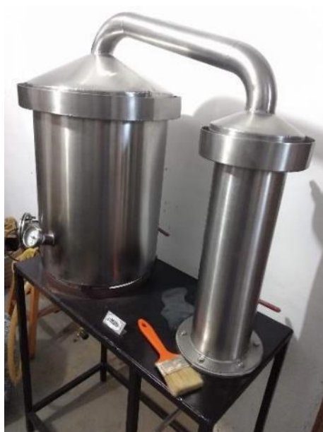
Figura 51: Equipamento para extração de óleo essencial, utilizado para a atual atividade econômica da família.
