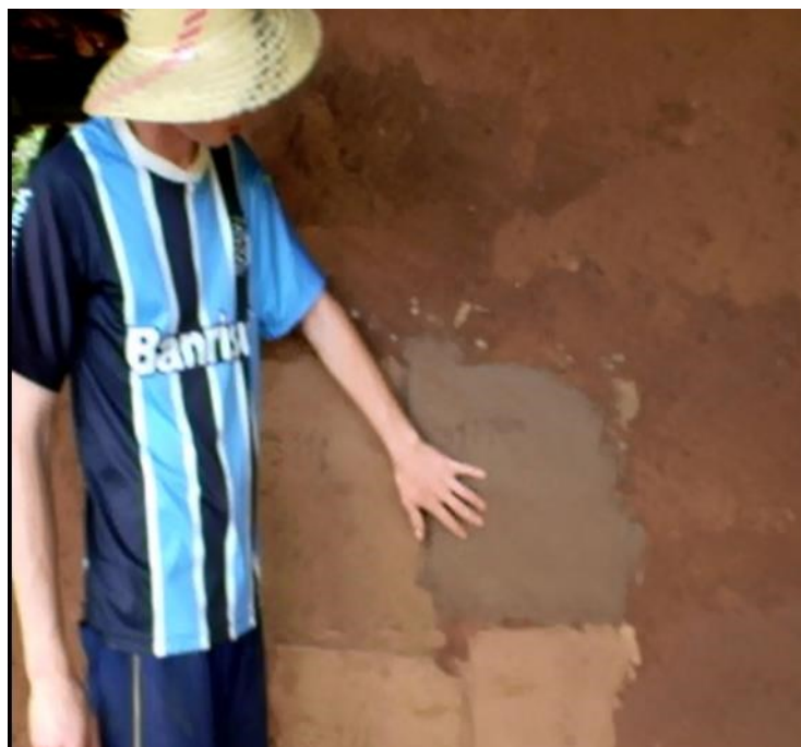
Figura 69: Agricultor participante de oficina experimentando diversos traços para reboco. Foto de 2009.
