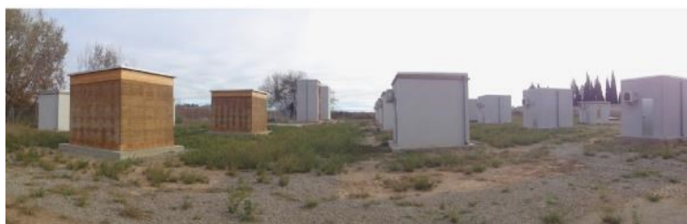
Figura 21: Experimento comparativo entre paredes de taipa de pilão e vedações convencionais em alvenaria. Fonte: Serrano, Gracia e Cabeza (2016).
