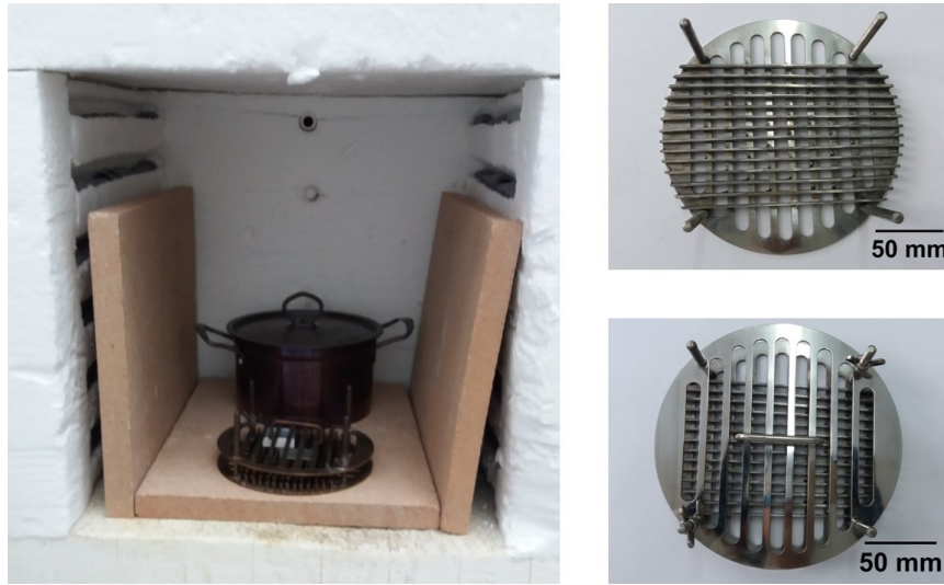
Figura 5 – Fotografias mostrando o conjunto construído e utilizado para troca iônica em banho de sal de \text{NaNO}_3 .
