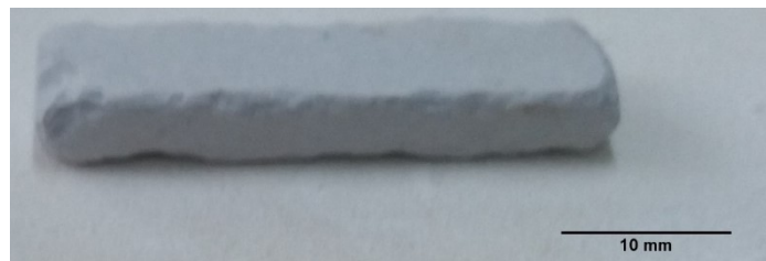
Figura 6 – Fotografia mostrando o aspecto geral da superfície de uma amostra de LZSA queimada a 850\text{ }^\circ\text{C} por 30 min, submetida ao banho de sal de \text{NaNO}_3 a 550\text{ }^\circ\text{C} por 3 h.
