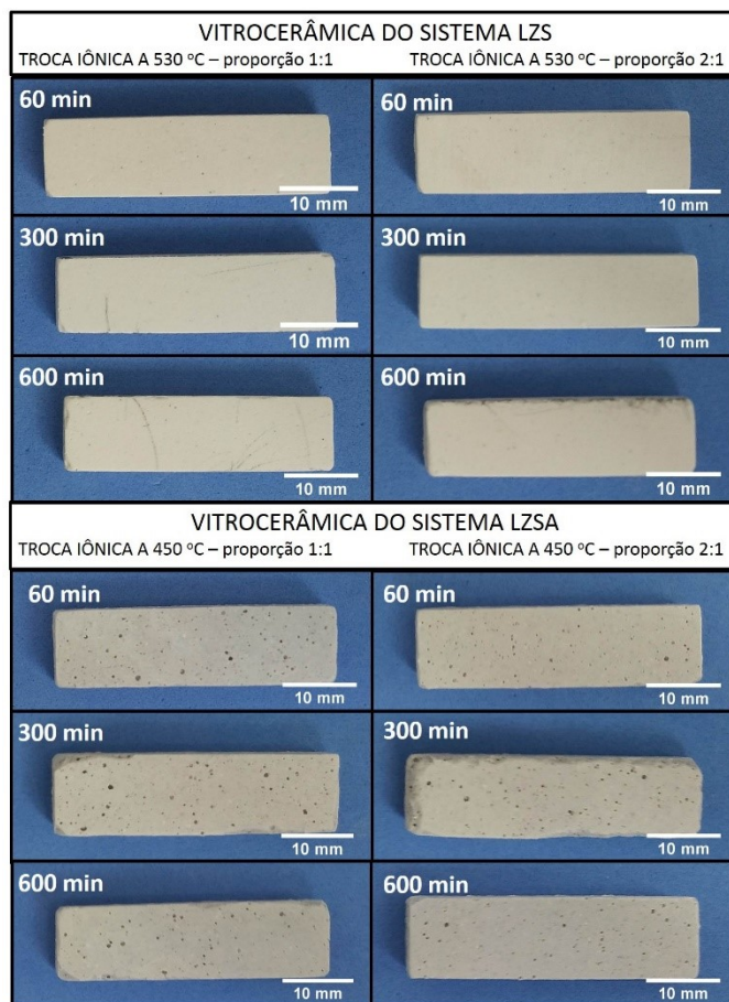
Figura 31 – Fotografia mostrando o aspecto geral das vitrocerâmicas dos sistemas LZS e LZSA após troca iônica com pasta de sal de \text{NaNO}_3 em diferentes condições.
