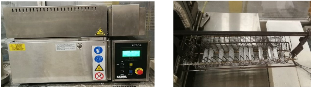
Figura 7 – Fotografia do forno e porta-amostra utilizados na troca iônica em banho de sal de \text{KNO}_3 .
