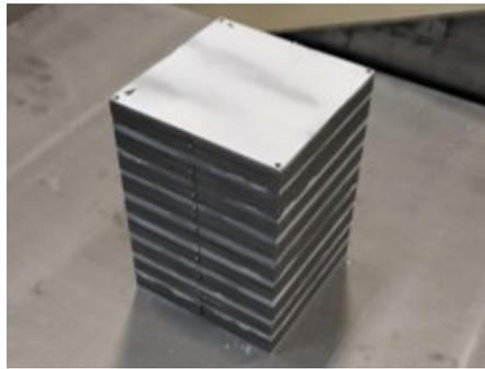
Figura 3.8 - Empilhamento completo dos CP's com aplicação de HBN.
