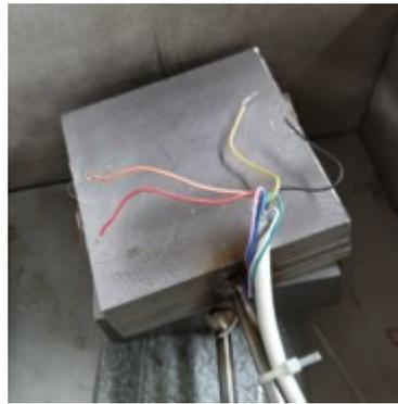
Figura 3.11 - Corpo de prova preparado para o teste de ciclagem de pressão.
