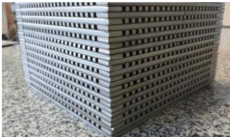
Figura 2.5 - Núcleo de um trocador de calor unido por difusão.
