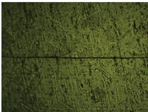
Figura 3.29 - Trinca no CP5.
