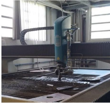
Figura 3.6 - Corte da geometria por jato d'água.
