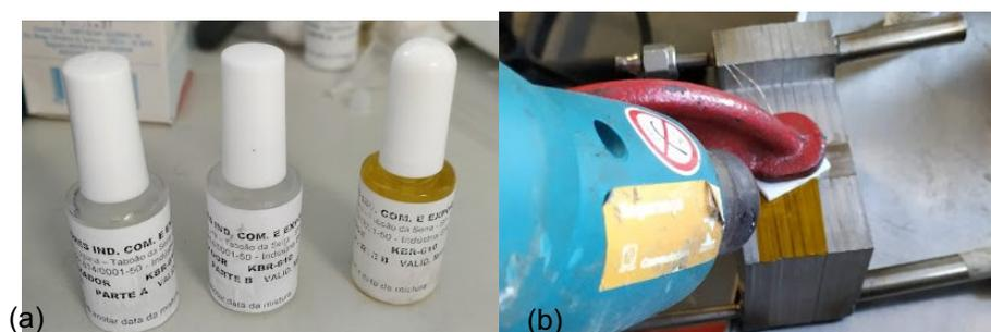
Figura 4.17 - (a) Fixador KBR-610; (b) Realização da cura para colagem do sensor.
