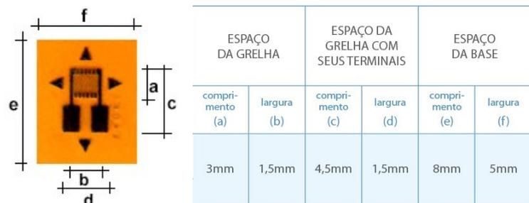
Figura 3.12 - Dimensões dos extensômetros
