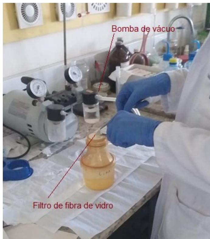
Por fim, para todas as amostras, foram realizadas as análises no Laboratório Integrado do Meio Ambiente (LIMA/UFSC). Primeiramente, foi realizada a extração da clorofila-a, por meio do acréscimo de 5 ml de acetona 90% em um tubo, inserção do filtro, maceração, adição de mais 5 ml de acetona 90%. Os tubos eram mantidos refrigerados entre 2 e 24 horas, onde, então, eram colocados em uma centrífuga à 3000 rpm, durante 20 minutos.
