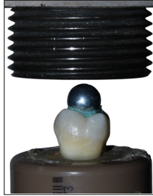
Figura 28. Corpo-de-prova posicionado na máquina universal de ensaios mecânicos para a realização do teste de compressão.
