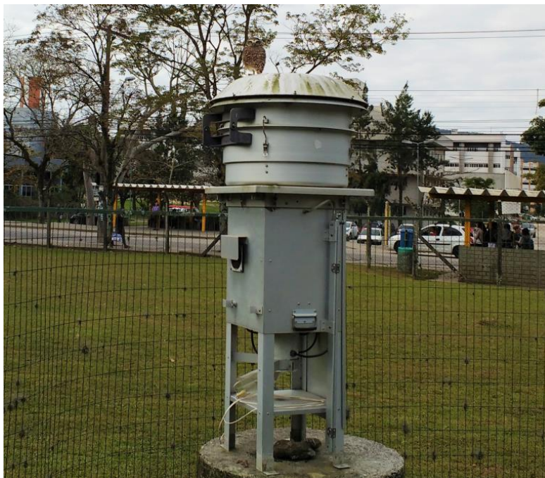
Figura 10: AGV-MP 10 localizado na UFSC, Florianópolis/SC.
