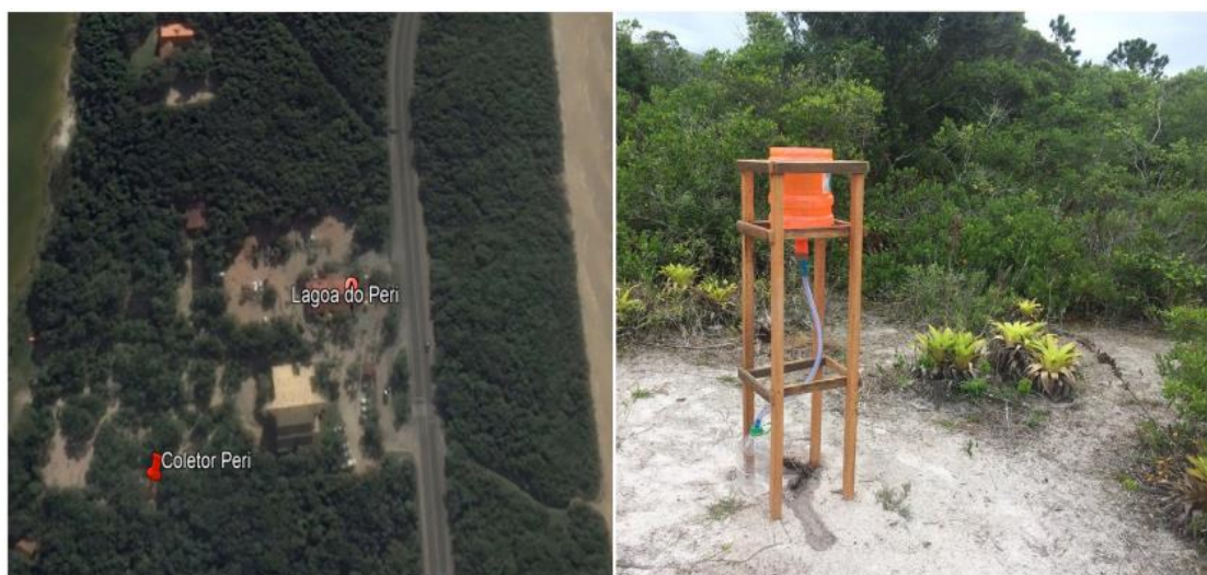
Figura 9: Coletor pluviométrico localizado no Parque Municipal da Lagoa do Peri, Florianópolis/SC.
