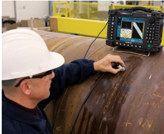
Figura 5 - Aplicação da técnica ultrassom em uma tubulação (SPEM, 2021).
