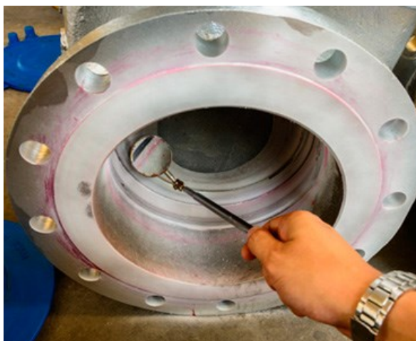
Figura 4 - Processo de inspeção visual (SPEM, 2021).
