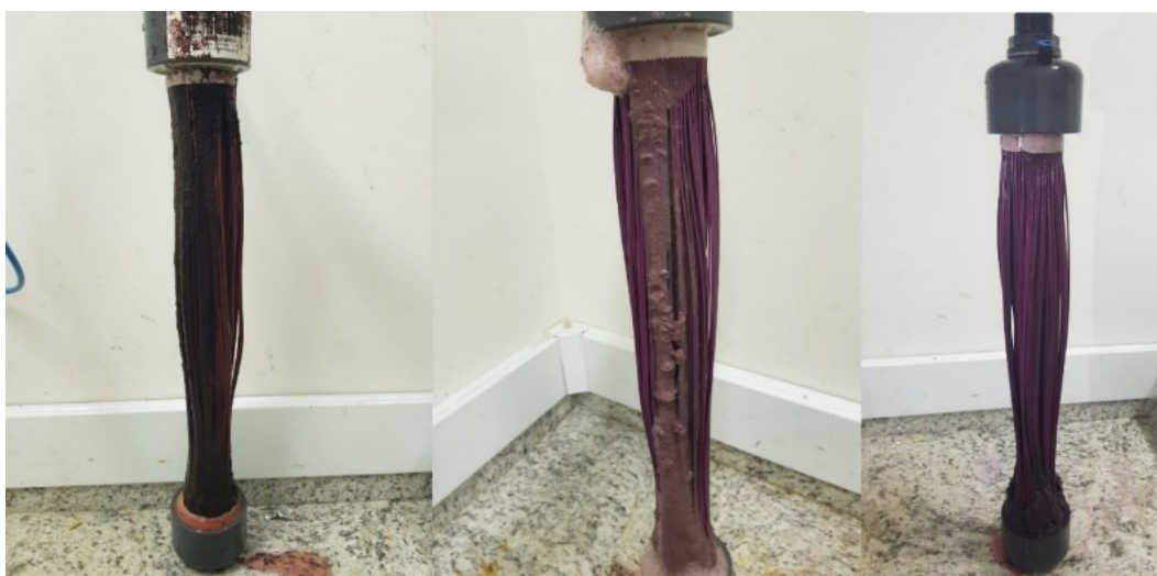
E-1: etapa sem eletrocoagulação; E-2.1: EBRM-H com eletrodo de aço; E-2.2: EBRM-H com eletrodo de alumínio
