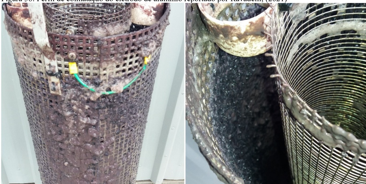
Figura 56: Perfil de colmatção do eletrodo de alumínio reportado por Ravadelli, (2021)
