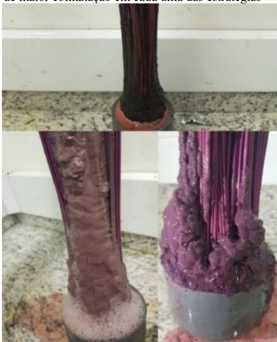
Figura 47: Detalhes dos pontos de maior colmatação em cada uma das estratégias
