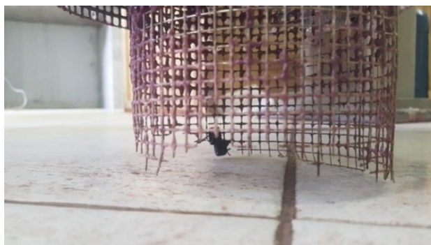
Figura 51: Aspecto da degradação do eletrodo de aço no fim da E-2.1, 62 dias após o início do seu uso como ânodo
