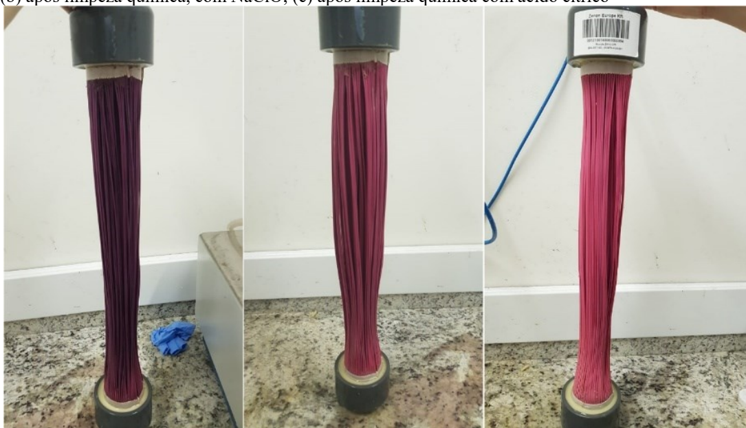
Figura 48: Aspecto do módulo de membranas após cada uma das etapas de limpeza: (a) após limpeza física com água; (b) após limpeza química, com NaClO; (c) após limpeza química com ácido cítrico
