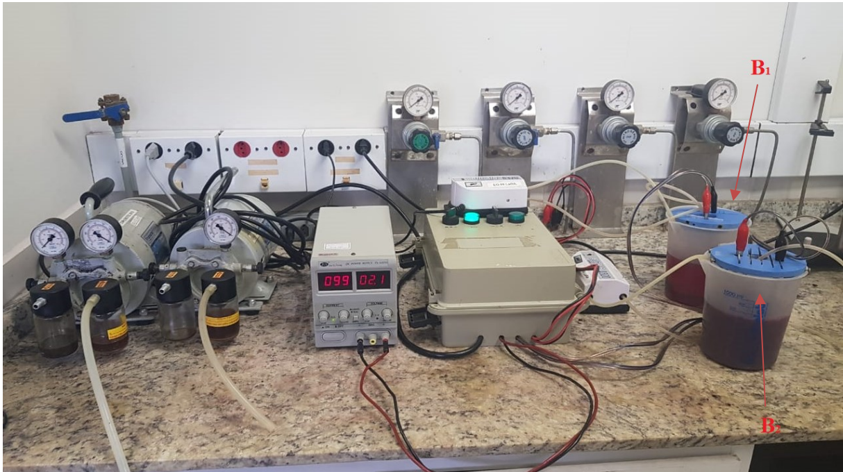
Figura 20: Aparatos utilizados para os ensaios de determinação do potencial de remoção do azo corante em diferentes densidades de corrente
