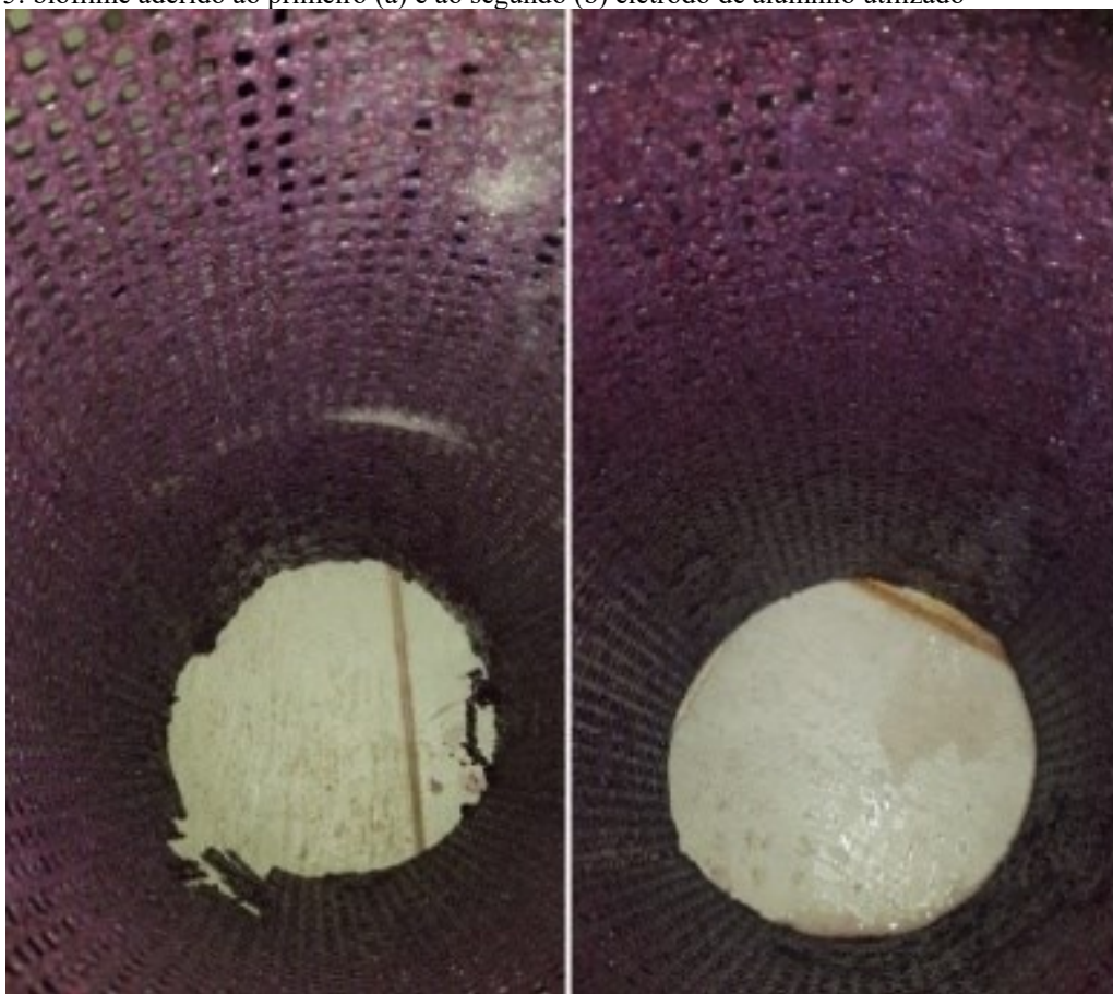
Figura 55: biofilme aderido ao primeiro (a) e ao segundo (b) eletrodo de alumínio utilizado
