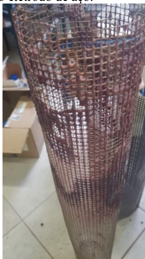
Figura 52: Aspecto do biofilme formado no eletrodo de aço.
