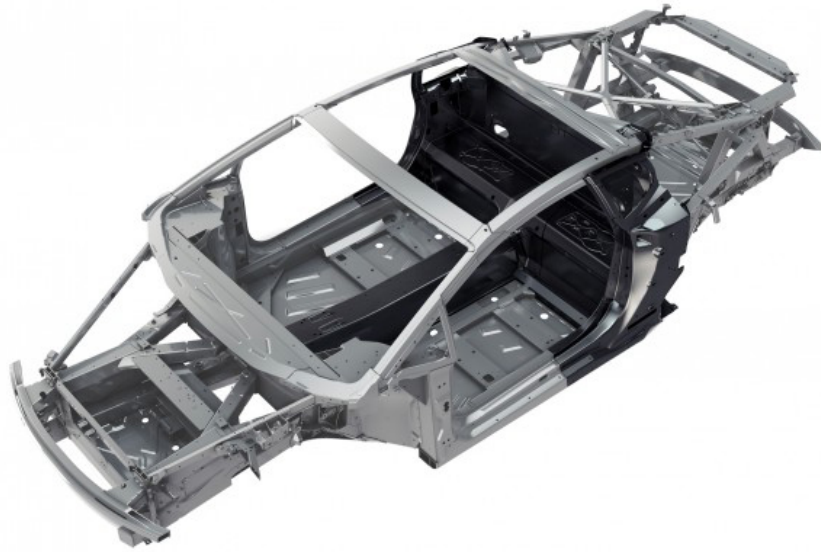
Figura 8 – Chassi do tipo monobloco
