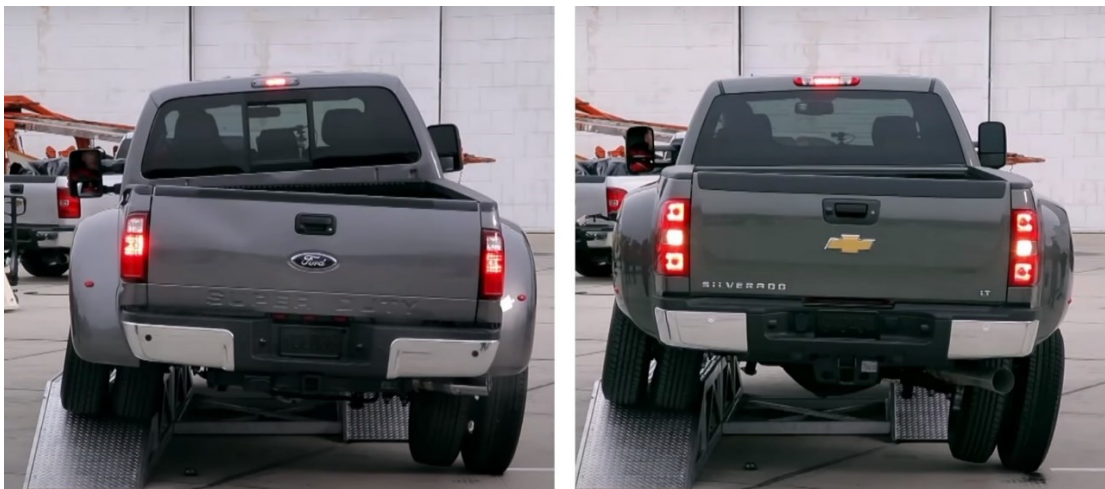
Figura 7 - Deformação torcional em veículos.
