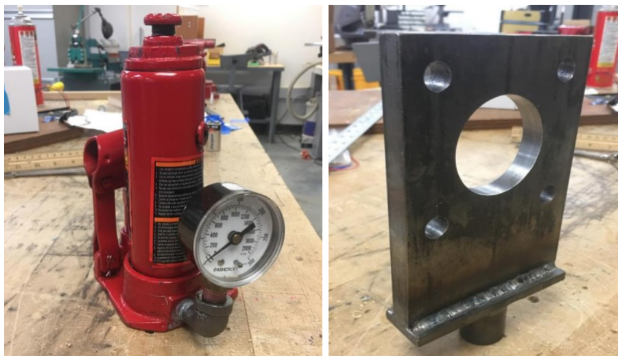
Figura 24 - Macaco hidráulico modificado e suporte para a fixar as mangas de eixo frontais do veículo.
