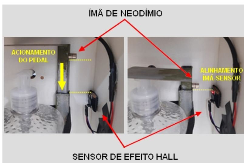
Figura 16 – Posicionamento e modo de funcionamento do sensor de acionamento
