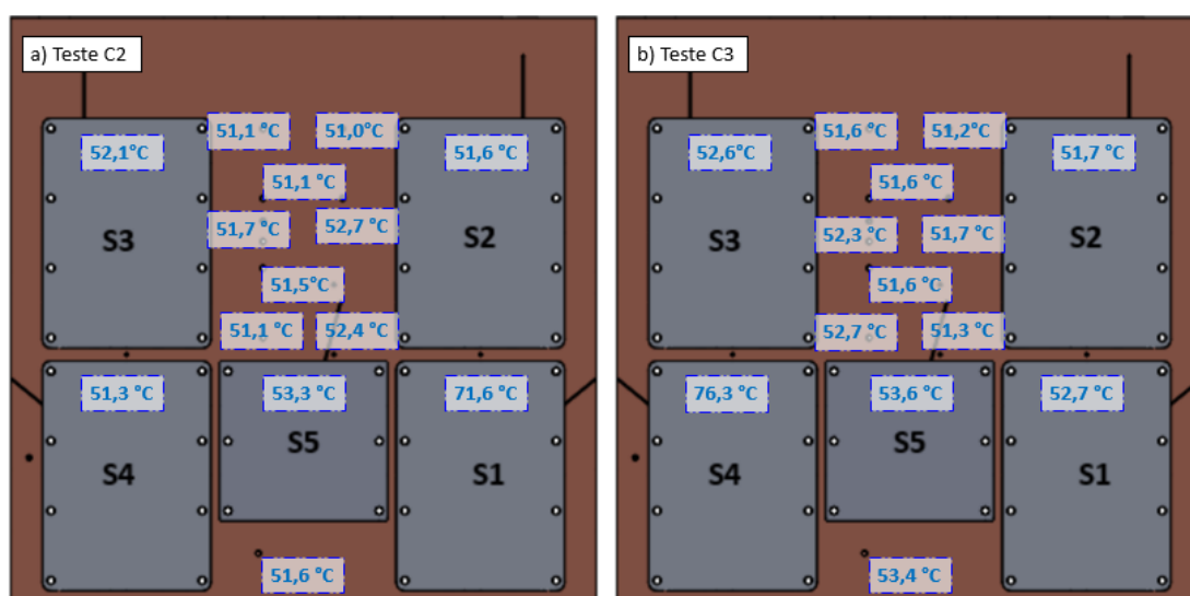
Figura 102: a) Distribuição de temperaturas na superfície do evaporador para o teste C2 – patamar de potência 4. b) Distribuição de temperaturas na superfície do evaporador para o teste C3 – patamar de potência 4.
