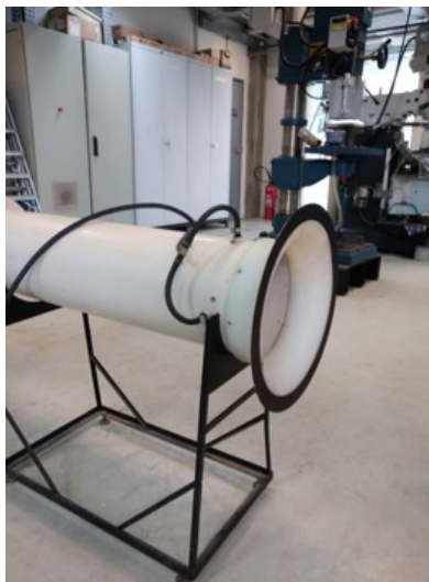
Figura 61: Tomadas de pressão no bocal de sucção.
