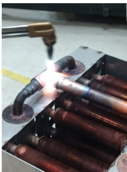
Figura 36: União por brasagem das duas partes do condensador.
