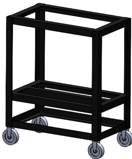
Figura 50: Desenho 3D do carrinho se suporte do termossifão.
