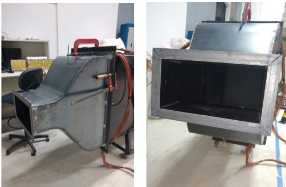
Figura 49: Bocal pronto e pré-fixado ao túnel de vento.
