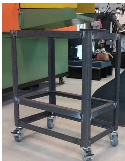
Figura 51: Carrinho de suporte fabricado em cantoneiras de aço.
