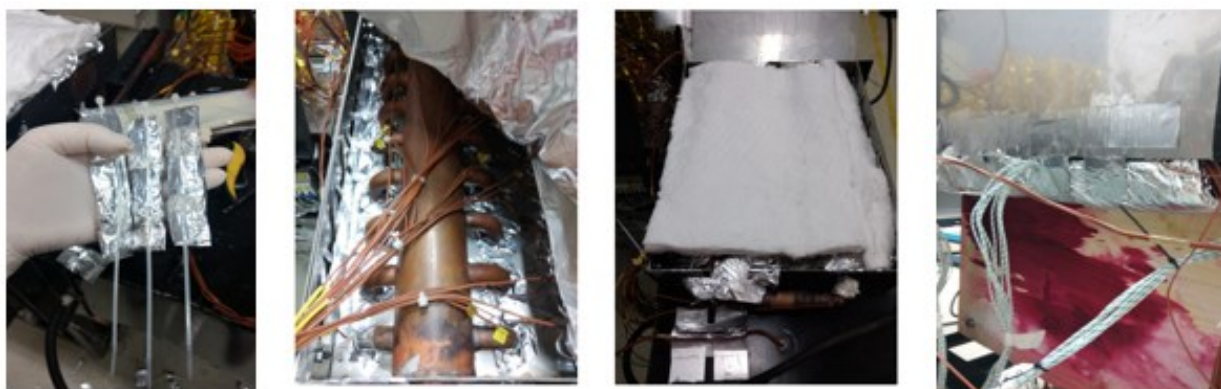
Figura 64: Isolamentos utilizados no termossifão
