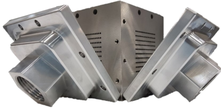
Figura 6 – Núcleo de trocador compacto de arranjo cruzado impresso por manufatura aditiva
