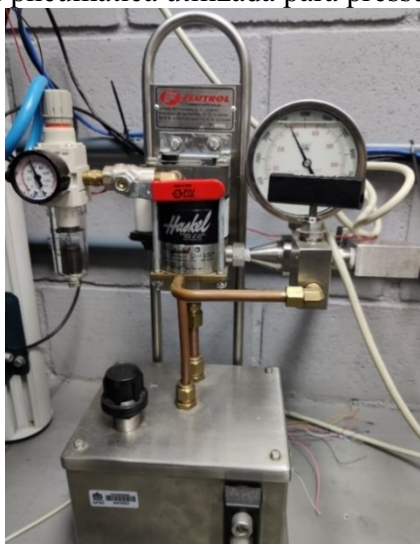
Figura 30 – Bomba pneumática utilizada para pressurização hidrostática
