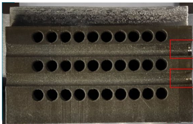
Figura 51 – Corte realizado na amostra 1A para avaliação da integridade estrutural
