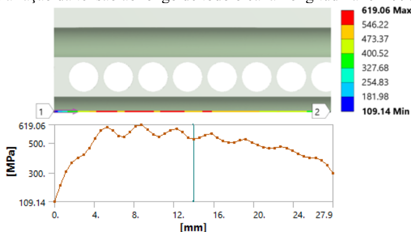
Figura 63 – Variação da tensão ao longo de todo o canal longitudinal em \frac{1}{4} da geometria 1
