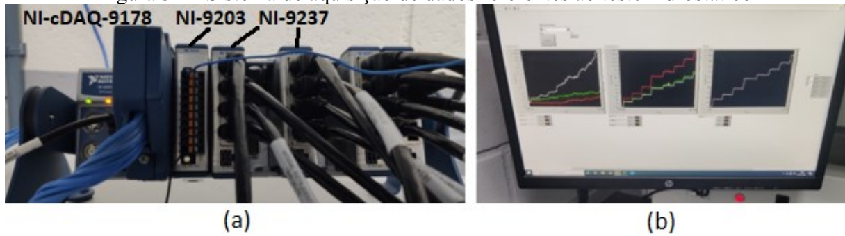
Figura 31 – Sistema de aquisição de dados referentes ao teste hidrostático
