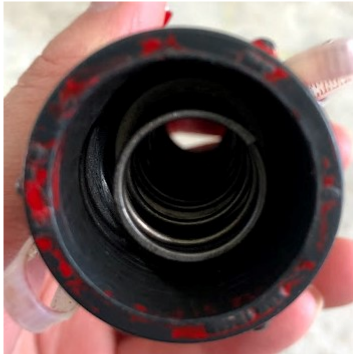
Figura C.5 – Vista inferior do suporte para transdutores, no qual é visível o conjunto de molas.
