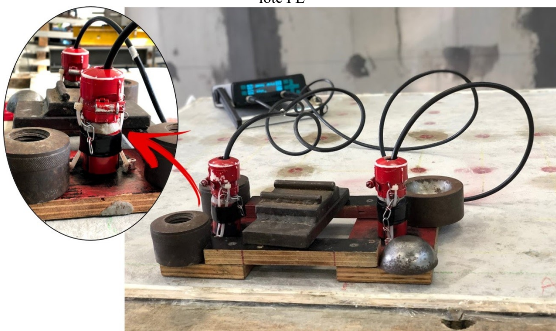
Figura 30 – Aparato utilizado para controle de pressão durante ensaio no corpo de prova do lote PL
