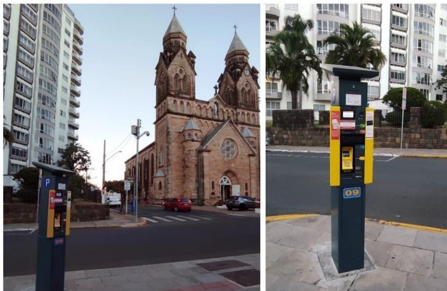
Figura 29 - Parquímetros de Estacionamento (Funcionamento por Coletor Solar)
