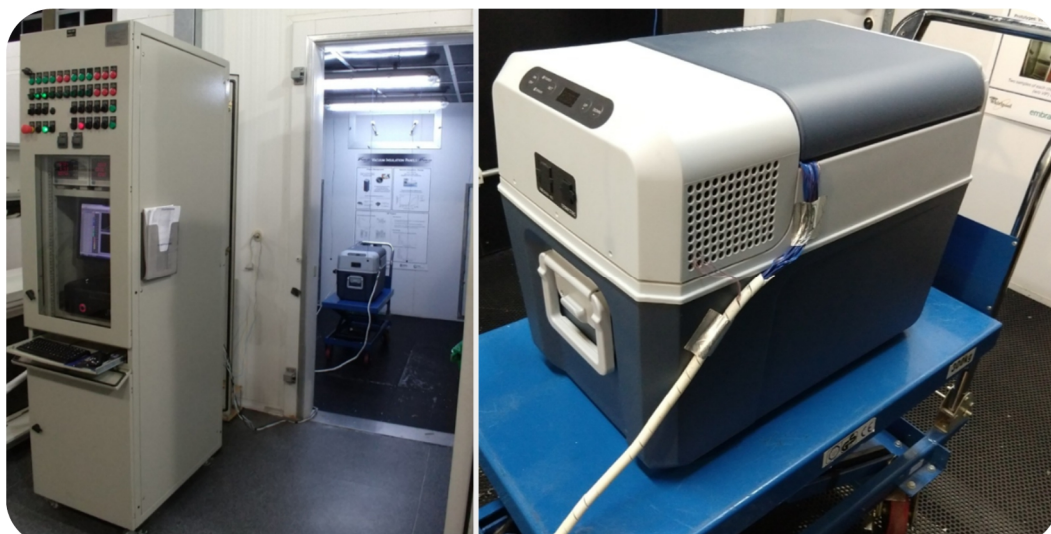
Figura 2.8 – Cooler portátil CMV instrumentado e instalado na câmara de testes
