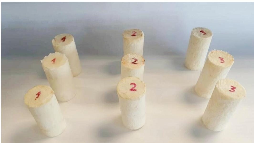
Figura 3. Amostras de compósitos PU (1), PU + Poliamida 30% (2) e PU + poliamida 40% (3).
