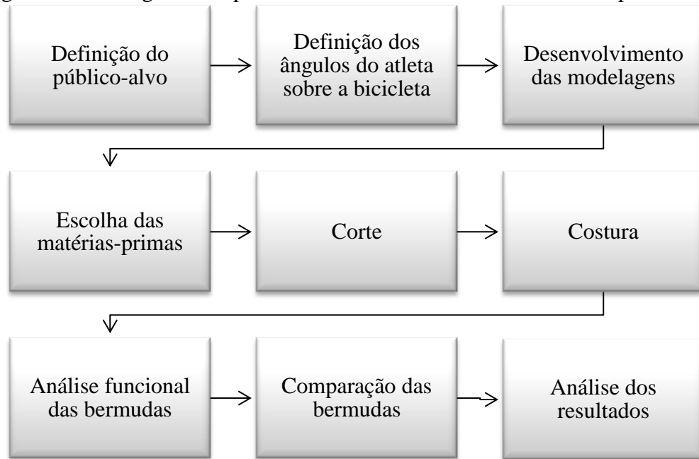
Figura 10 - Fluxograma do processo de desenvolvimento da bermuda para ciclista
