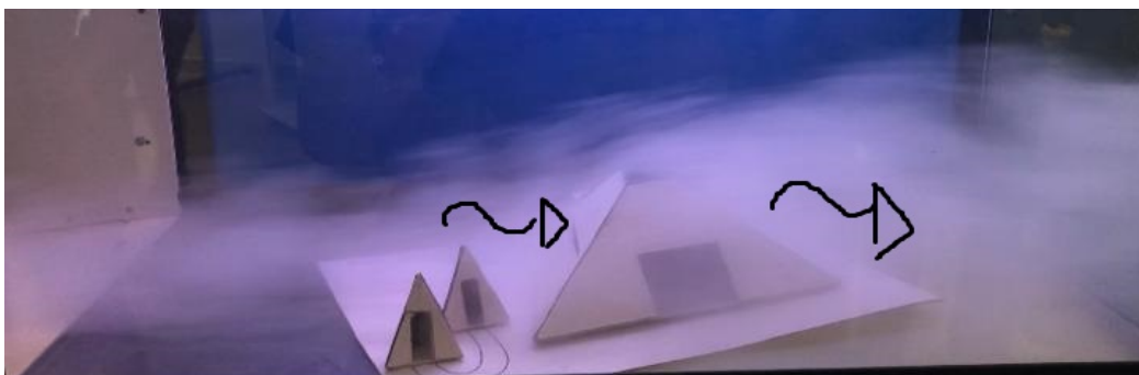
Figura 11. Simulação do vento nordeste no túnel de vento. Fonte: elaborado pelos os autores.
