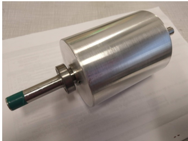
Figura 98 – Rotor de aço maciço do motor estudado no LAPLACE.
