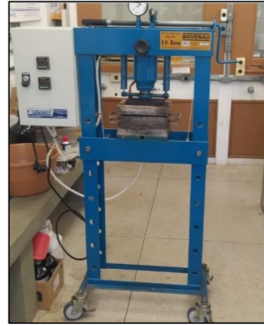
Figura 17 - Prensa hidráulica utilizada para confecção das pastilhas.
