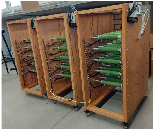
Figura 48 – Banco de resistores.
