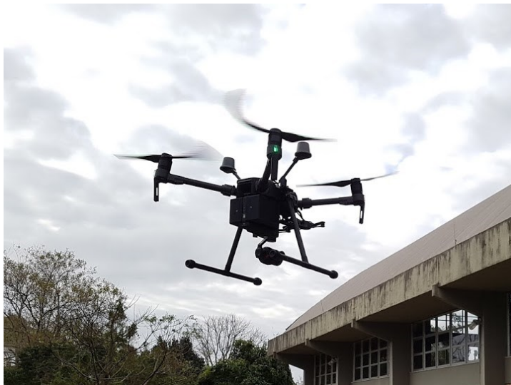
RPAS realizando as aquisições com a X5S
