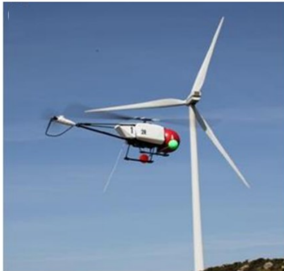
(a) RPAS equipado com uma câmera IR FLIR 650 realizando o voo.
