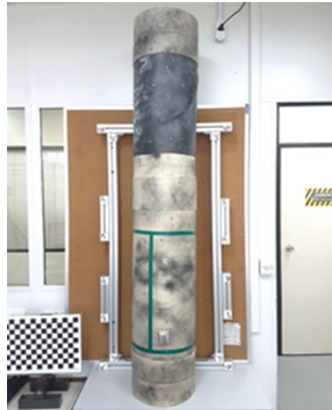
(b) Cena contendo simulacro de riser com defeitos e escalas para medição
