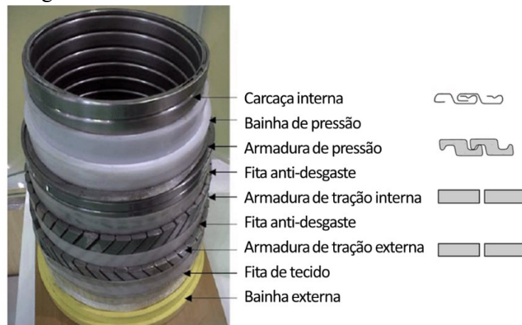
Figura 5 – Detalhe das estruturas internas de um riser
