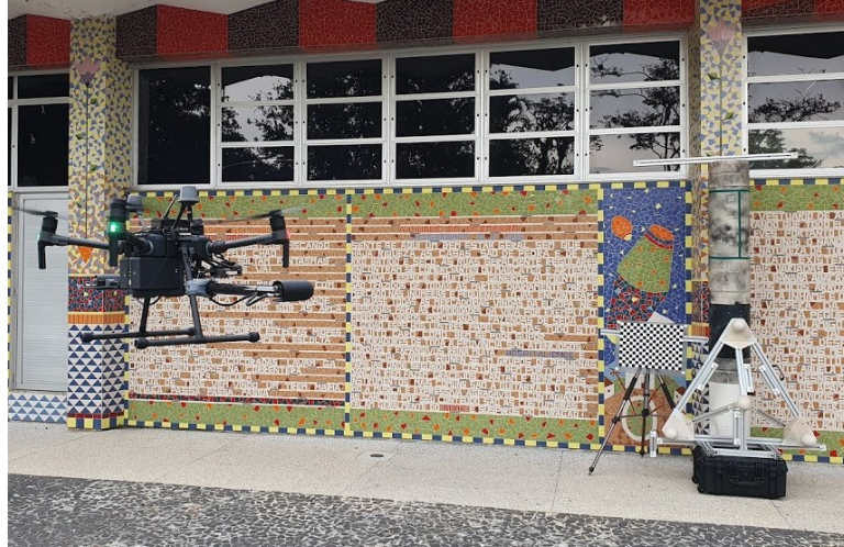
Figura 69 - RPAS com SV3D durante ensaio. A cena de interesse inclui: simulacro de riser , padrão de esferas com escalas e padrão 2D para calibração de câmera.
