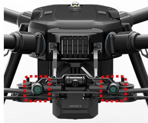
(b) Exemplo de sistema estéreo integrado ao RPAS DJI M210 V2 para detecção de obstáculos.
