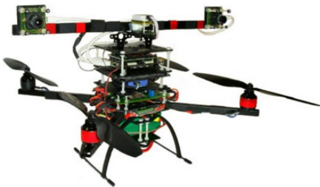
(a) RPAS com câmeras estéreo montadas para auxílio em voo autônomo.
