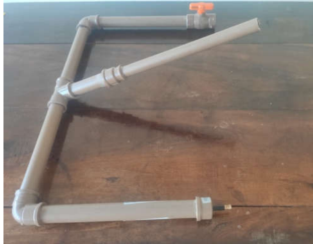
Figura 16: Montagem concluída da base de lançamento.
