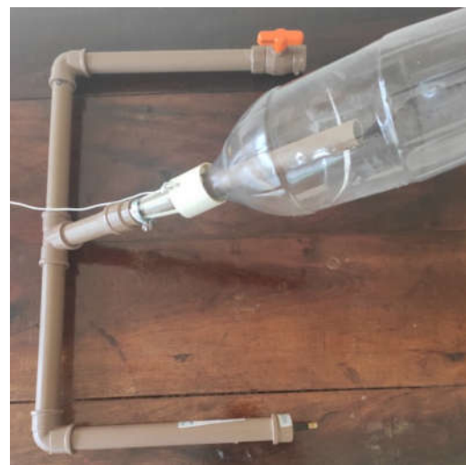
Figura 18: Foguete na base preso com o gatilho.
