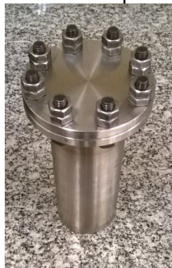
Figura 6 – Autoclave em aço inoxidável utilizado para sínteses hidrotermais ou solvotermiais.
