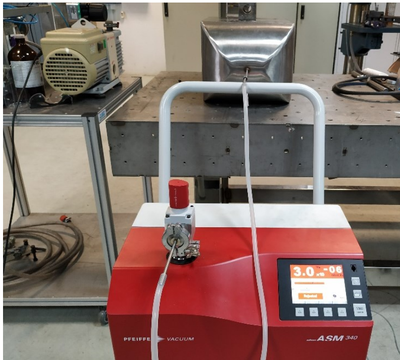
Figura 6.20 – Aparato conectado em uma bomba de vácuo mecânica.
