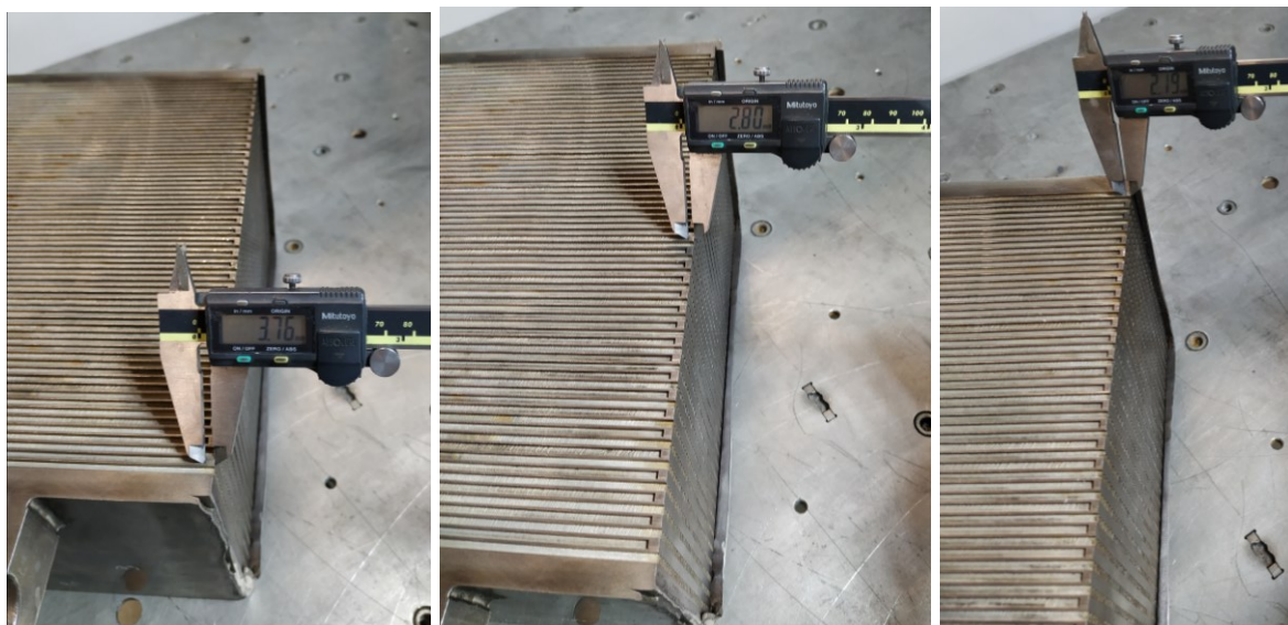
Figura 6.56 - Medições da borda resultante após usinagem.
