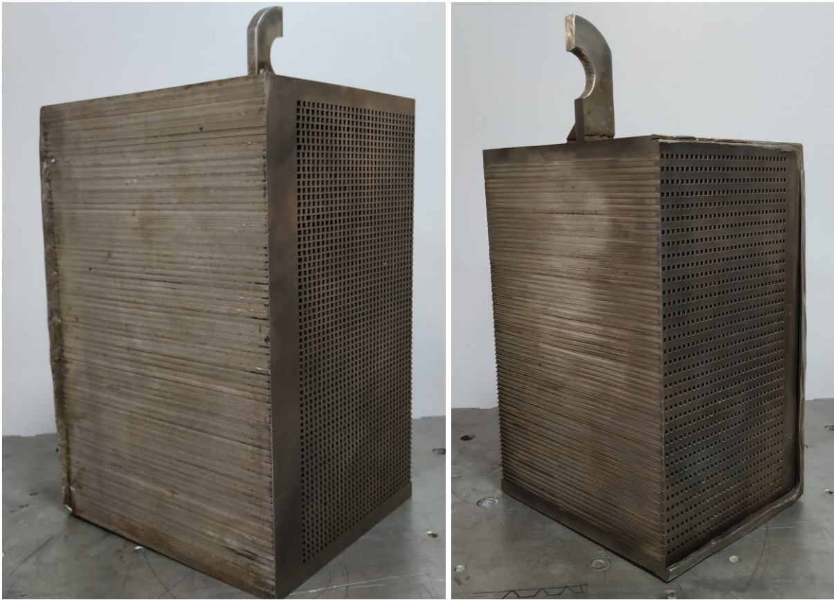
Figura 6.58 - Quarto quadrante, após o fatiamento do núcleo.
