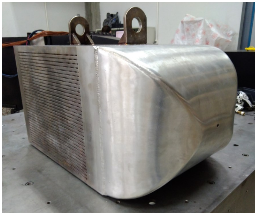
Figura 6.17 - Bocal soldado na face do núcleo.
