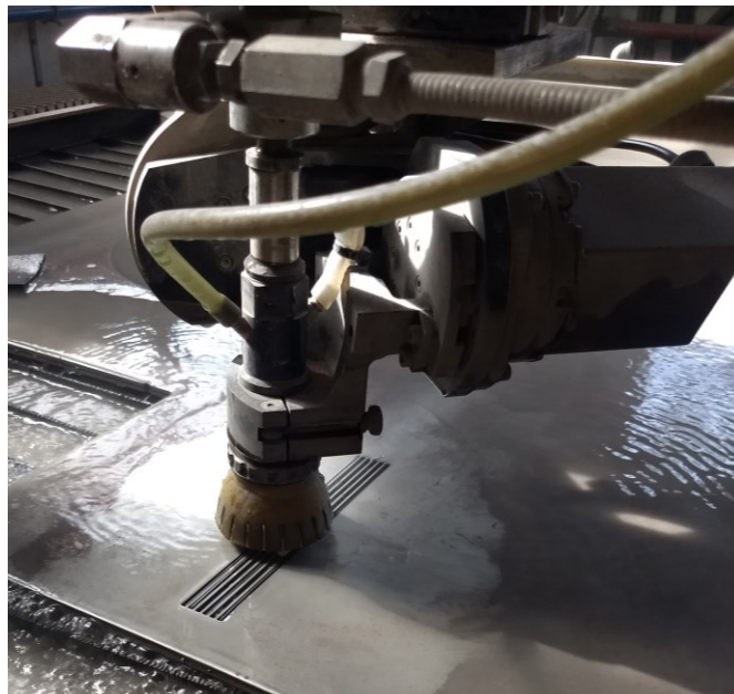
Figura 3.2 - Usinagem das placas do núcleo.
