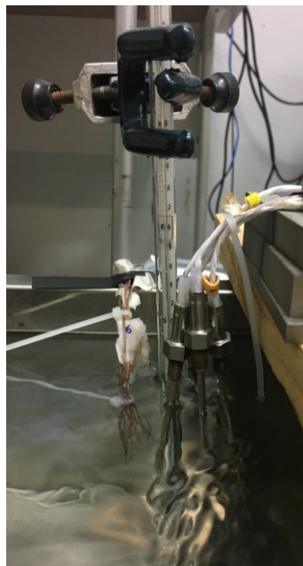
Figura D3 – Termopares e termômetro imersos em banho térmico.
