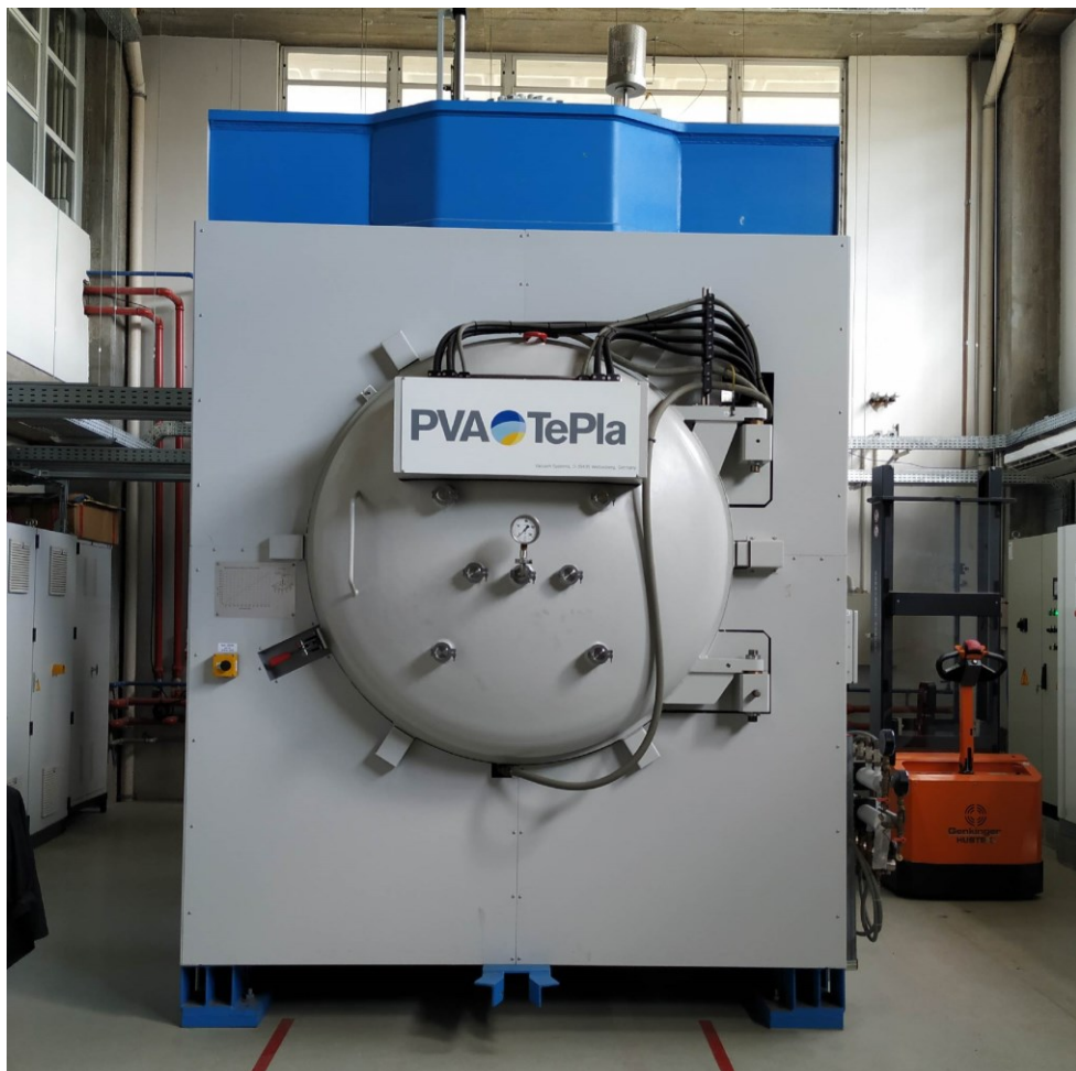
Figura 3.8 – Forno de união por difusão disponível no Labtucal.
