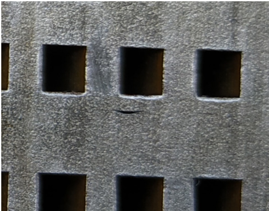
Figura 6.34 - Falha pontual no lado direito inferior.
