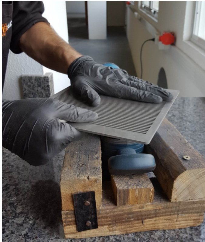
Figura 3.3 - Remoção de rebarbas.
