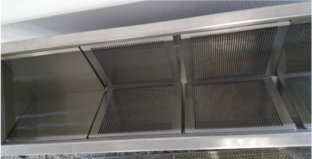
Figura 3.4 - Placas mergulhadas em banho ultrassônico com álcool etílico.
