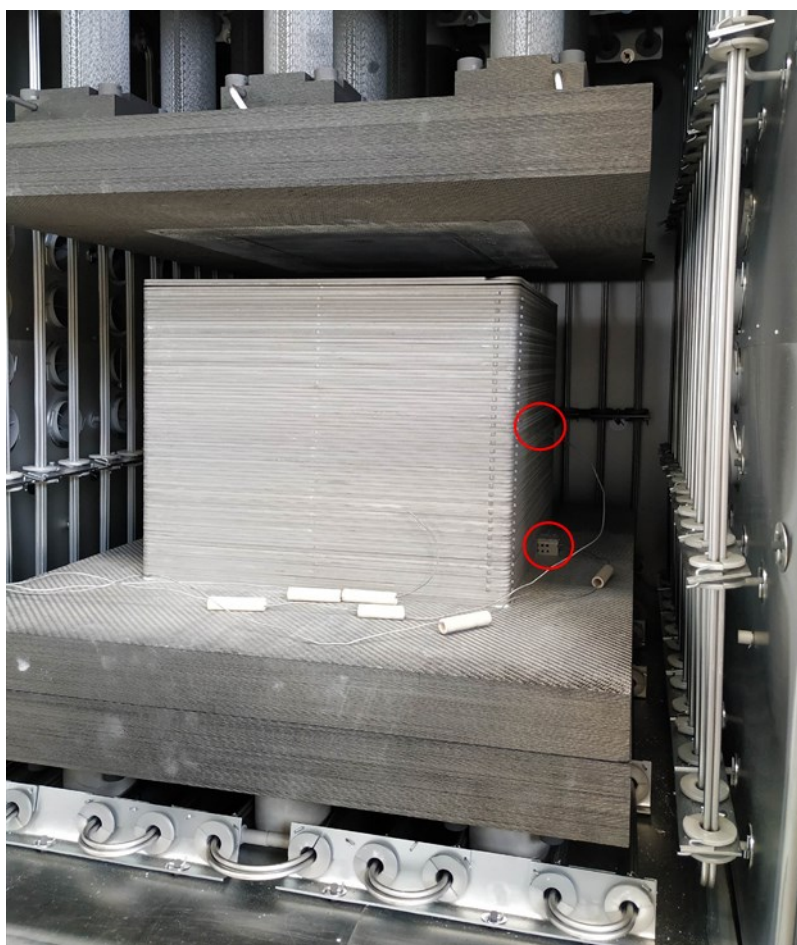
Figura 6.9 - Detalhe do posicionamento dos termopares na lateral e no interior das placas empilhadas.
