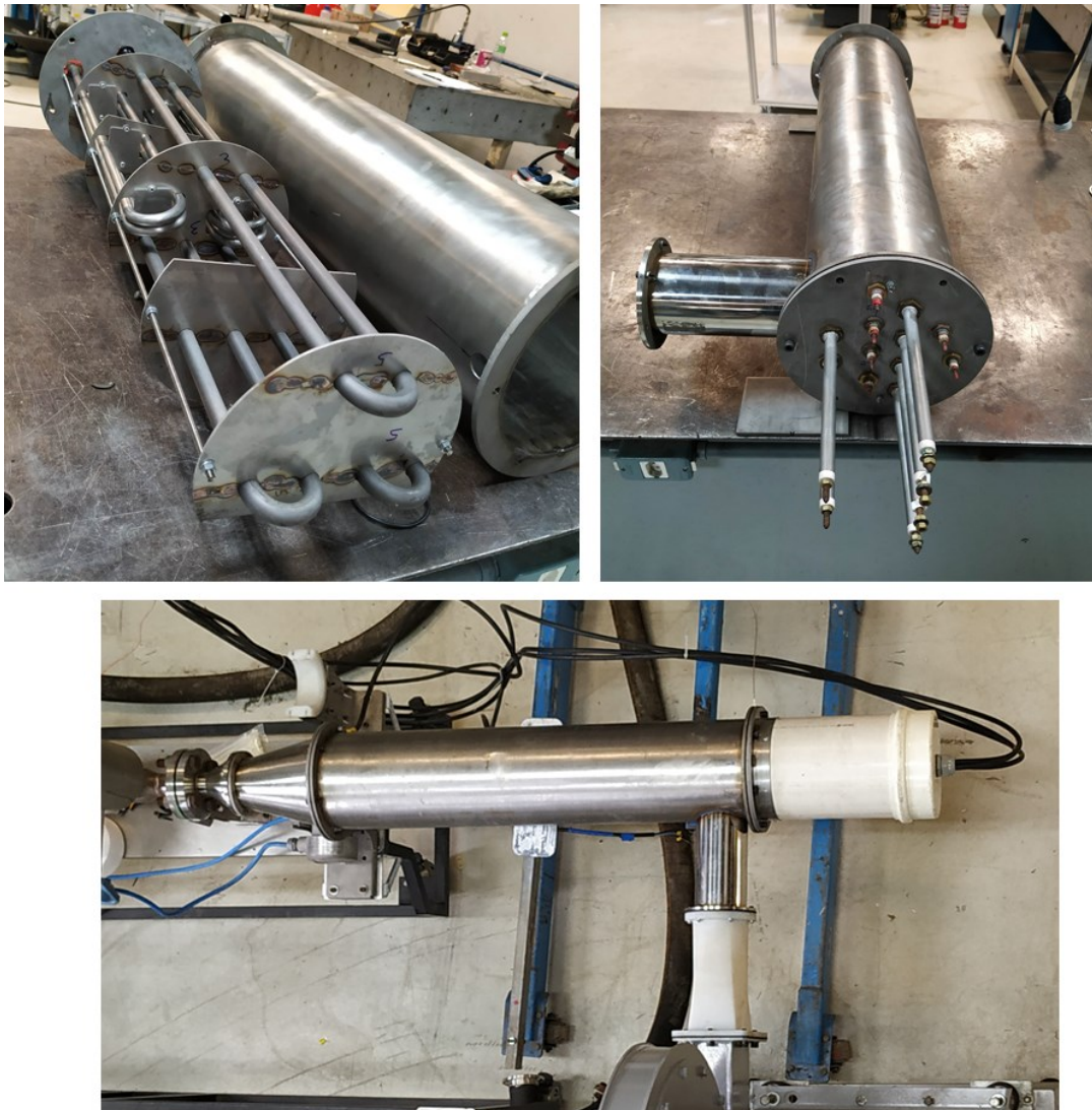
Figura 4.7 – Aparato para aquecimento do ar.
