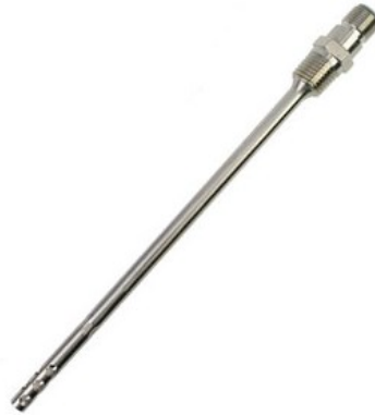
Figura 4.8 - Sonda RTD para mensurar a temperatura do ar.
