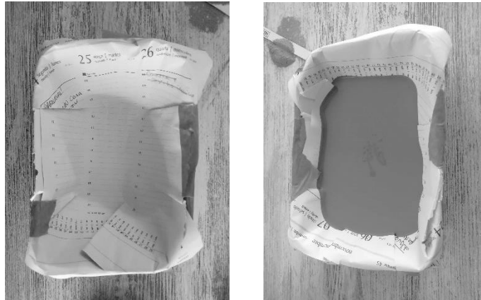
Figura 11 – Molde de papel – Enchimento da peça
