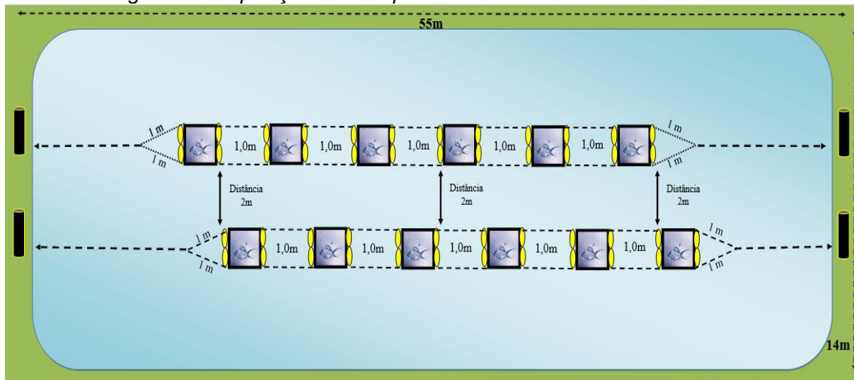
Figura 1 – Disposição dos tanques-rede em viveiro de terra escavado.
