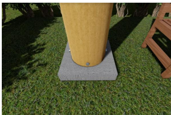
Figura 17: Detalhe da base com tubo de papelão fixado. Fonte: Elaborado pelos autores.
