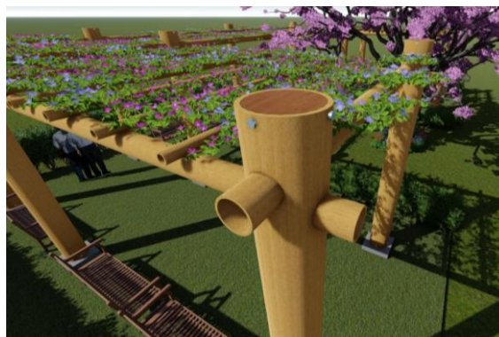
Figura 16: Detalhe da perfuração e transpasse dos tubos de papelão e da bolacha de madeira parafusa ao topo. Fonte: Elaborado pelos autores.
