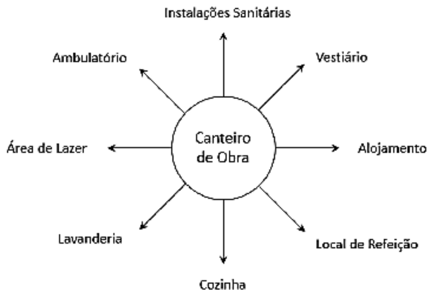
Figura 1: Instalações a se dispor em um canteiro de obra. Fonte: Lessa, 2019.
