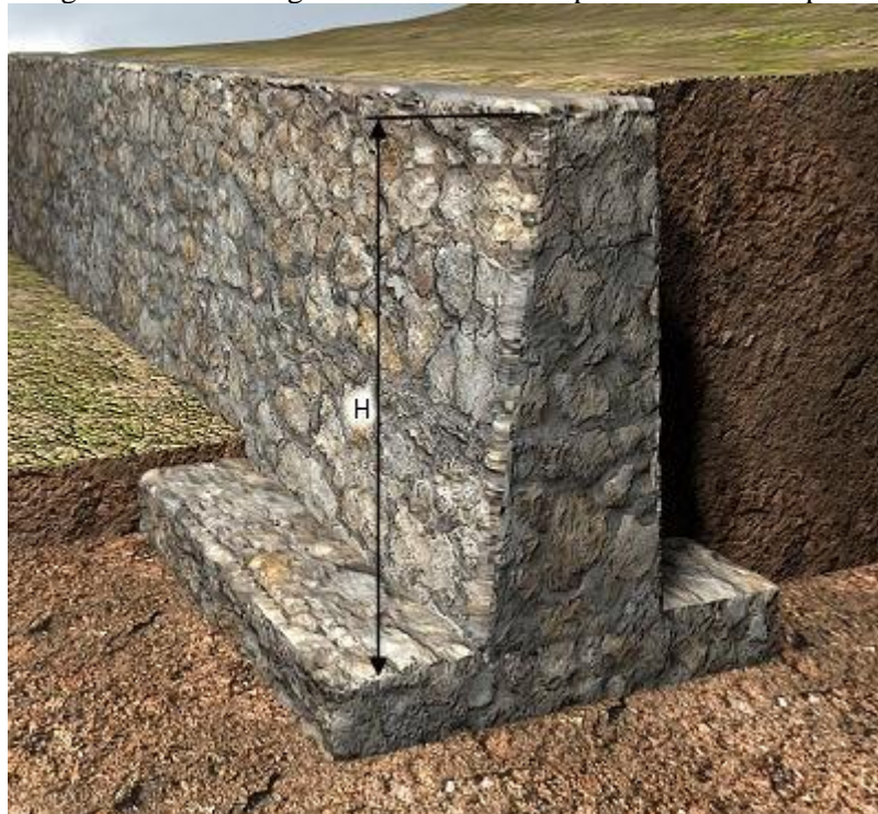
Figura 5 - Muro de gravidade constituído por concreto ciclópico
