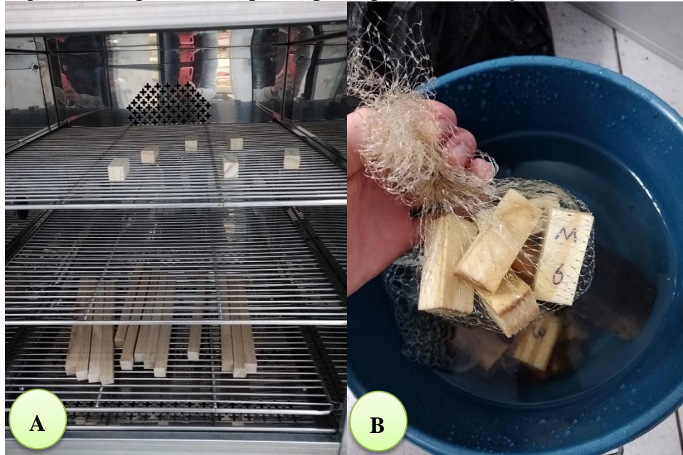
Figura 3 – Preparo dos corpos de prova para determinação das densidades.
