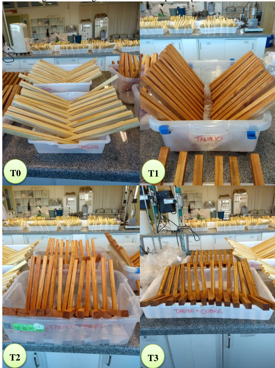
Figura 5 – Secagem natural dos corpos de prova tratados.
