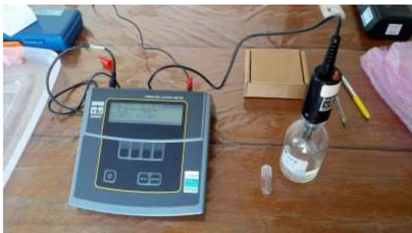
Figura 2. Oxímetro utilizado durante as coletas de amostras para medição do oxigênio dissolvido presente na água da lagoa de decantação.
