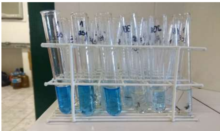
Figura 4. Amostras de água da lagoa de decantação em processo de análise do teor de amônio.
