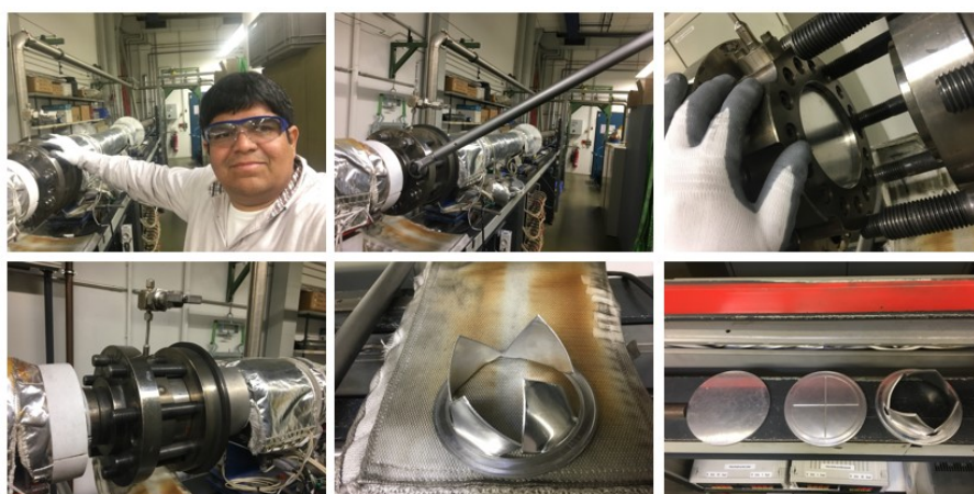
Figura 12: Registros fotográficos da visita no IVG/UDE, Fevereiro de 2018. Fotografias do tubo de choque, componentes e diafragmas usados nos experimentos de atraso de ignição
