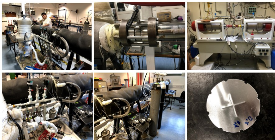
Figura 11: Registros fotográficos da visita no C3/NUIG, junho de 2018. Tubo de choque de alta pressão, máquina de compressão rápida, componentes periféricos e diafragma usados em experimentos de atraso de ignição
