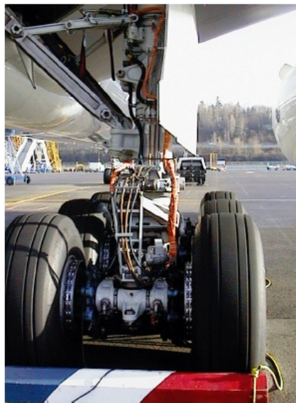
Figura 2 – Trem de pouso e seus diversos componentes
