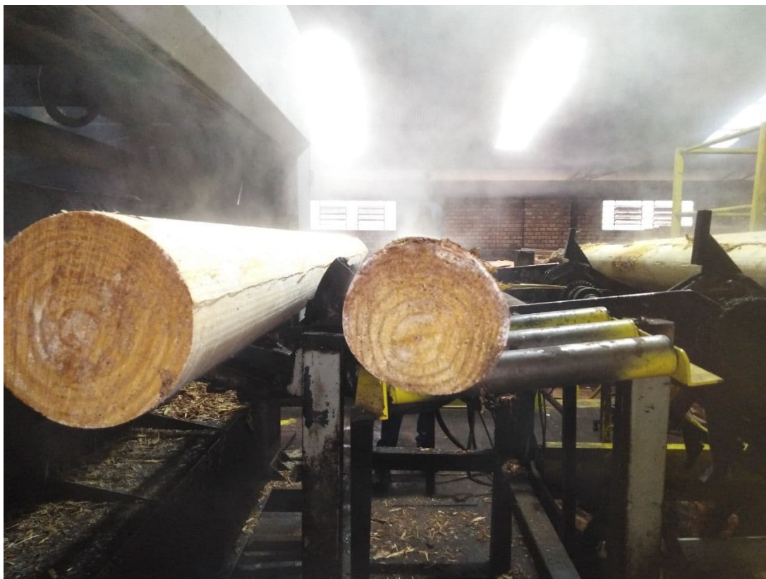
Figura 7 – Tora de madeira após o processo de arredondamento. Fonte: o autor.
