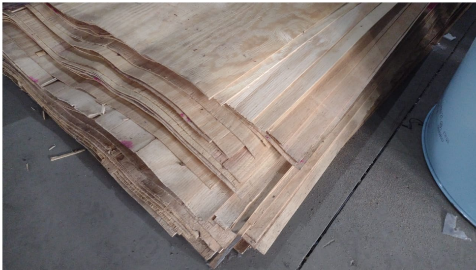
Figura 3 – Lâminas de madeira feitas através do processo de laminação de toras. Fonte: o autor.
