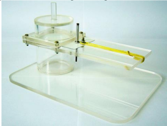
Figura 1 – Aparato para análise do tempo de dispersão de uma amostra
