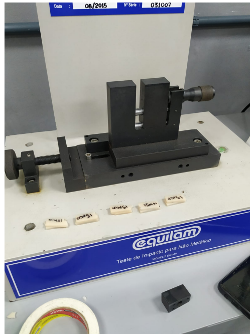
Figura 9: Corpos de prova após serem submetidos ao teste de impacto
