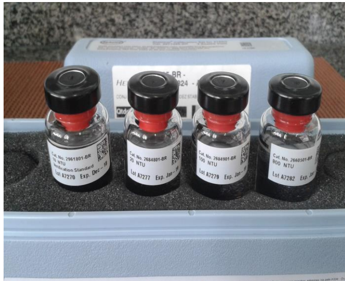
Figura 7 - Padrões de turbidez Formazina 10 - 20 - 100 - 800 NTU - Hach
